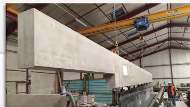
Poutre en béton pour la charpente d'un bâtiment sur-mesure
